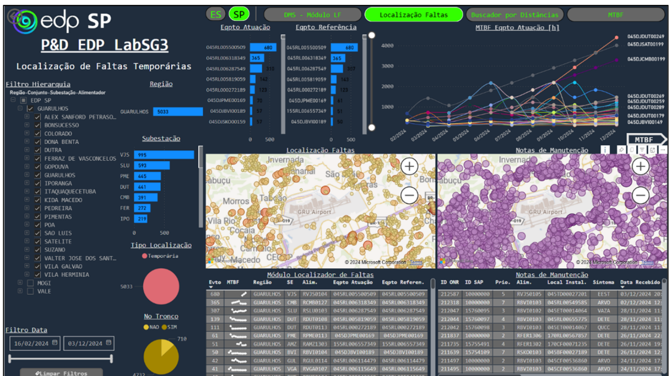
Figura 5 – Aplicação de filtros e navegação pelos dados do módulo e notas de manutenção.
