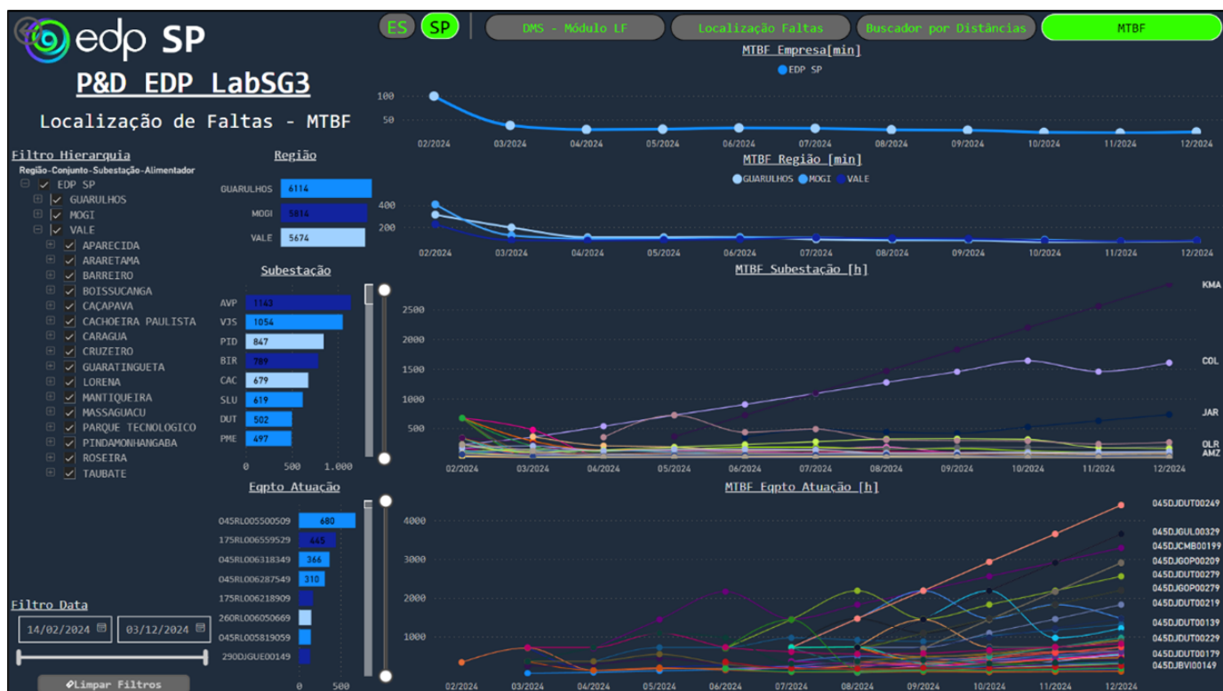
Figura 7 – Análise contínua do tempo médio entre falhas, MTBF.
